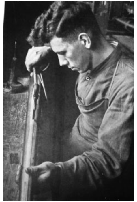
Löten der Längennabt einer Metallpfeife
